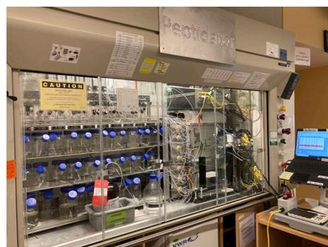
全自動固相フローペプチド合成装置
